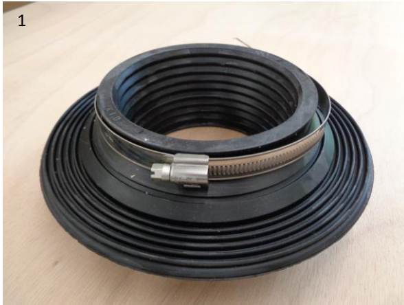
1 et 2 : Joint « Frank » avec collier de serrage pour passage de conduites verticales à travers un radier neuf (photo : ©Effiteam Sàrl). Ces joints sont à poser sur les tubes avant le coulage de la dalle béton.
