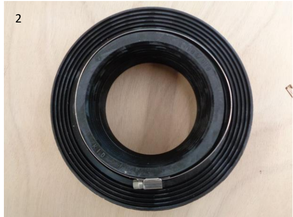
1 et 2 : Joint « Frank » avec collier de serrage pour passage de conduites verticales à travers un radier neuf (photo : ©Effiteam Sàrl). Ces joints sont à poser sur les tubes avant le coulage de la dalle béton.
