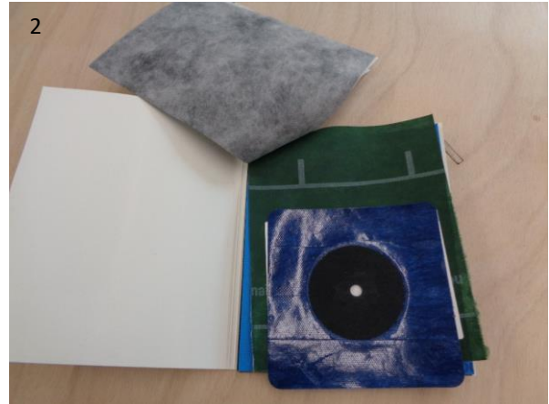
1 : Portes étanches d'accès au sous-sol vers des espaces non chauffés (ne pas utiliser de seuil abaissable ; seul un cadre de porte complet, avec des joints périphériques de calfeutrement sur tout le pourtour est efficace) ; 2 : Etanchéité à l'air et raccords pour passages de conduites (photo : ©Effiteam Sàrl)
