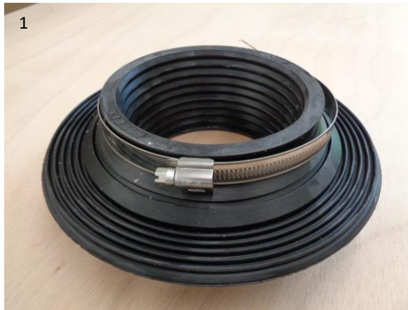
1 et 2 : Joint « Frank » avec collier de serrage pour passage de conduites verticales à travers un radier neuf (photo : ©Effiteam Sàrl). Ces joints sont à poser sur les tubes avant le coulage de la dalle béton.
